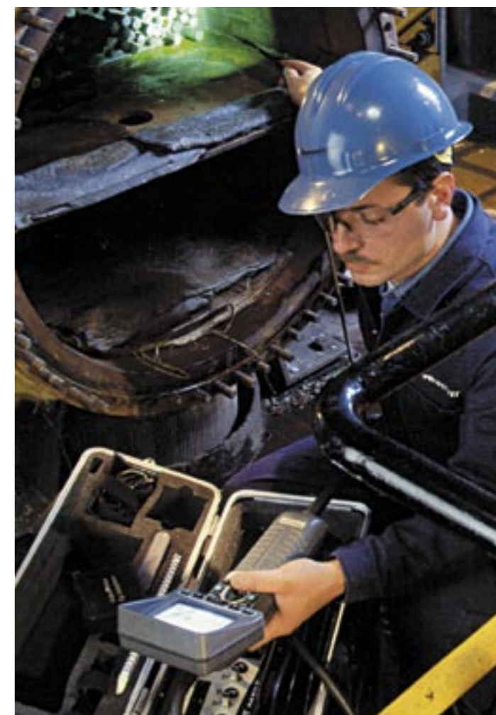
Wärmetauscher-Überprüfung mit dem Videoendoskop Everest XL PRO™ Videoprobe®
