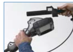
Schneller Wechsel: einstecken und fertig – so einfach lassen sich unterschiedliche Sonden mit dem Handteil verbinden.
